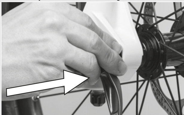
Figur 61: Skub hurtigbespændingen ind
