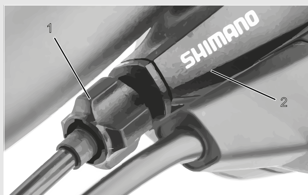
Figur 131: Slutmuffe (1) på gearskiftet med ét kabel og gearvælgerhus (2), eksempel
