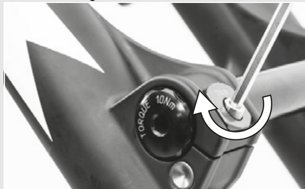
Figur 53: Tilspænding af sikringsklemme
