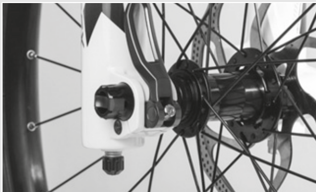
Figur 129: Indstilling af hurtigbespændingens spændekraft
