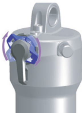
Figur 147: Hårdere indstilling på trykindstillingsanordning
