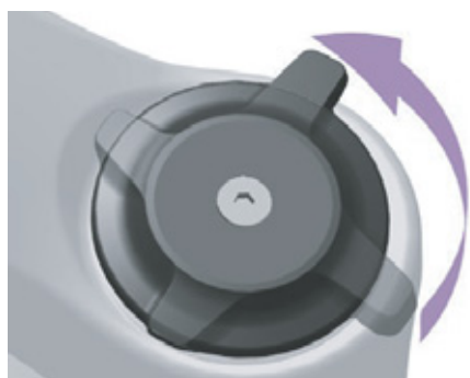
Figur 124: Blødere indstilling på trykindstillingsanordning
