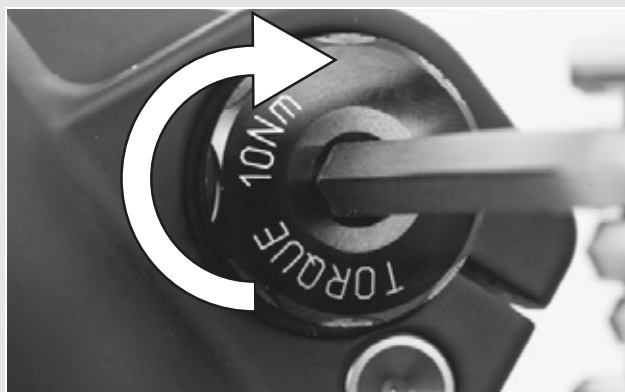
Figur 52: Spænd den monterede aksel
