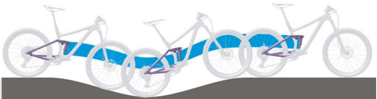
Figur 11: Bagdæmperen fungerer optimalt under kørsel i bakket terræn
