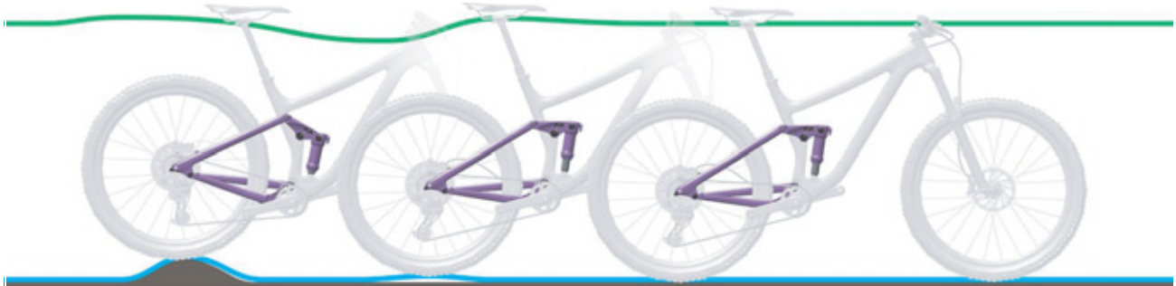
Figur 142: For hurtig tilbagefjedring på bagdæmperen
