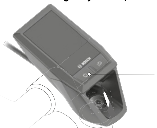
Figur 113: Tænd/sluk-tastens position (cykelcomputer)
