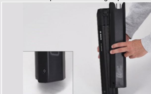
Figur 47: Skub batteridækslet på batteriet
