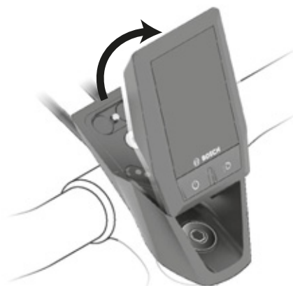
Figur 112: Afmontering af cykelcomputer
