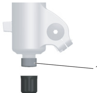
Figur 92: FOX-træktrinsindstillingsanordning (1) på gaffelenden
