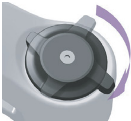
Figur 139: Hårdere indstilling på trykindstillingsanordning
