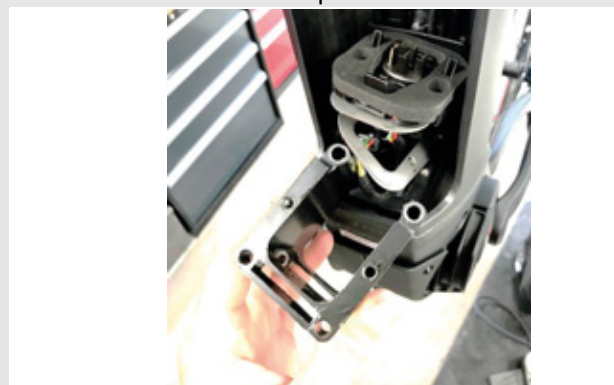
Figur 38: Træk PowerTube adapteren ud
