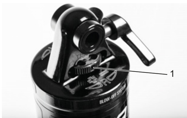
Figur 91: Hjul (1) for Suntour-træktrinsindstillingsanordning på bagdæmperen
