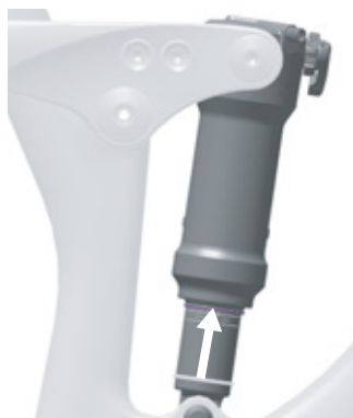
Figur 87: Forskyd O-ringen på bagdæmperen
