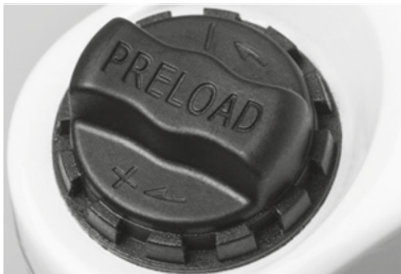
Figur 79: Indstillingshjul for SAG på fjedergaflens gaffelbro
