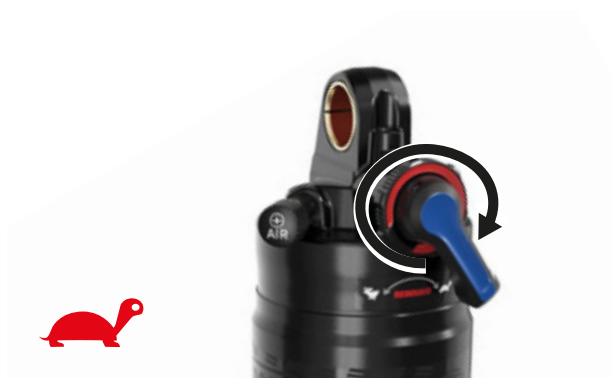
Figur 95: Reduktion af tilbagefjedringshastighed
