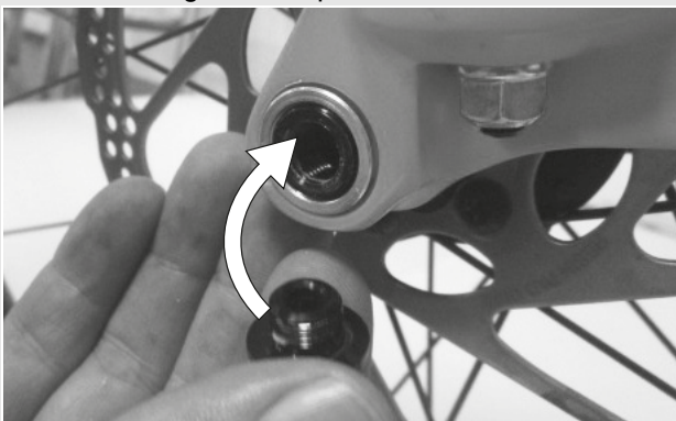
Figur 50: Skub hurtigbespændingen ind i akslen
