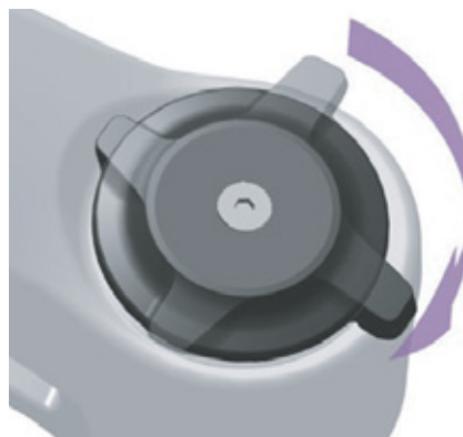
Figur 123: Hårdere indstilling på trykindstillingsanordning
