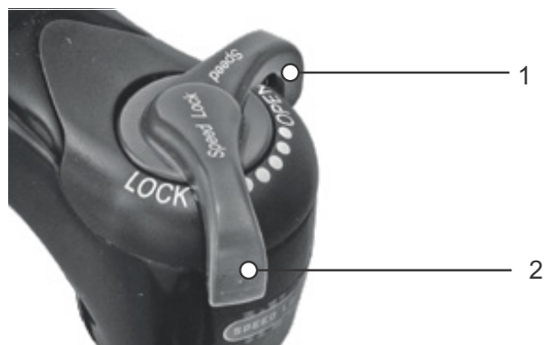
Figur 122: Suntour-trykdæmper i åben (1) og lukket (2) position
