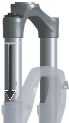
Figur 84: Forskyd O-ringen på fjedergafflen
