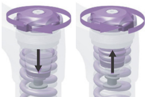
Figur 82: Inddrejning og uddrejning af indstillingsring for forspænding.
