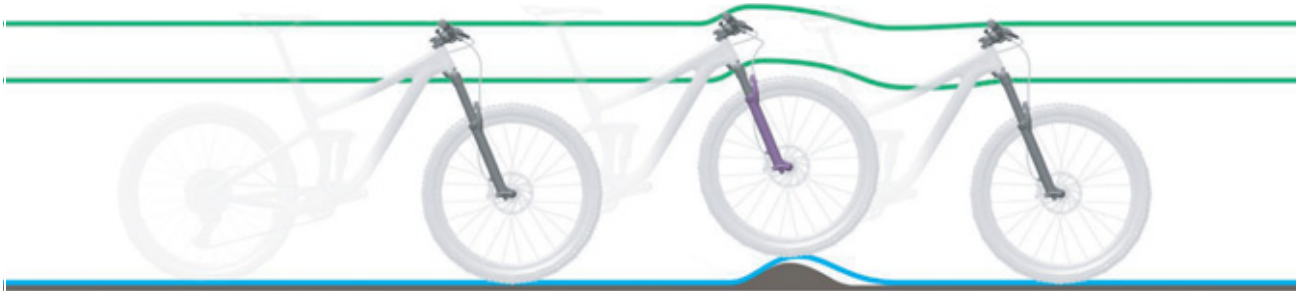
Figur 140: For hård dæmpning af fjedergafflen ved ujævnheder
