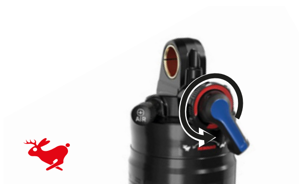
Figur 96: Øgning af tilbagefjedringshastighed
