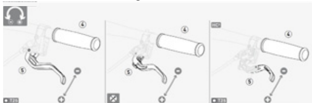
Figur 77: Indstilling af grebsbredden på Magura skivebremse bremsegreb
