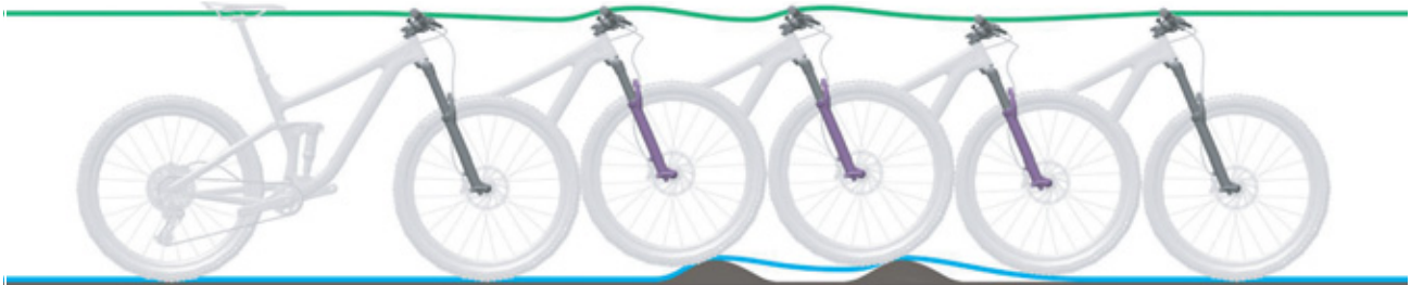
Figur 136: Fjedergaflen fjedrer for langsomt tilbage
