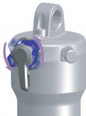
Figur 101: Blødere indstilling på trykindstillingsanordning
